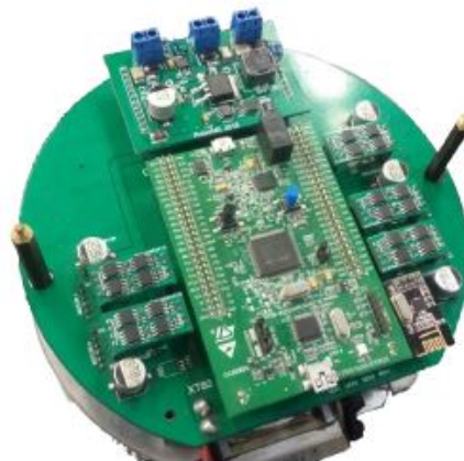
(b) Foto com todas as placas à mostra: a placa mãe, os cinco módulos de motor, o módulo de chute, a Discovery e placa de comunicação
